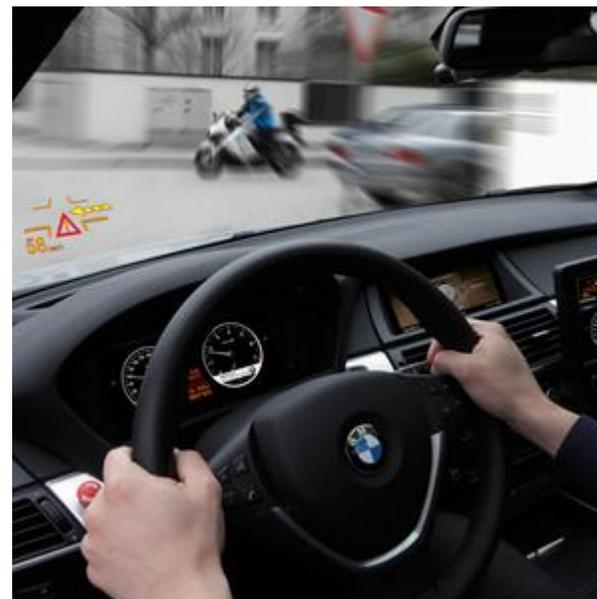
Übersehen ausgeschlossen: Der Kreuzungsassistent weist den Fahrer auf das Motorrad hin.
